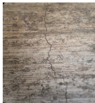
Рис. 5. Микротрещина на поверхности покрытия ПГ-СР4 после обработки МЭШ, \times 1000
