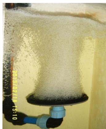
Рисунок 1 Аэраторы конструкции БрГТУ, патент на полезную модель № 9636
