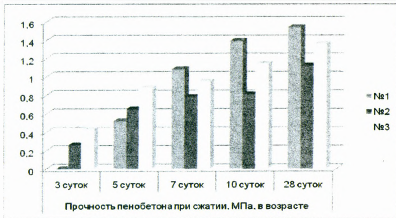
Рисунок 3 – Кинетика набора прочности пенобетона плотностью Д450, при марке цемента М500
