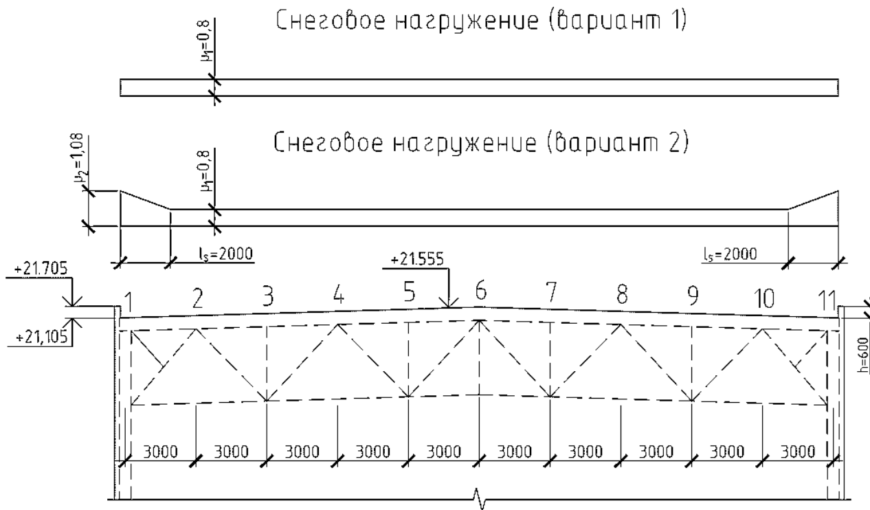
Рисунок 2.2 – Варианты приложения снеговых нагрузок на здание
