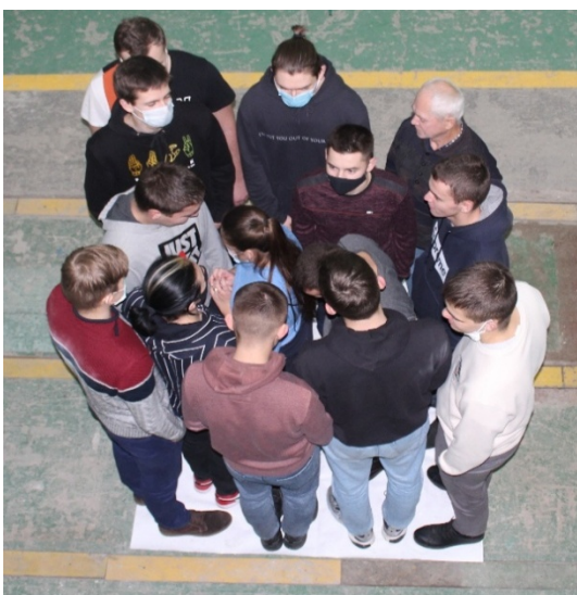
Рисунок 1.3 – Значения нагрузок на перекрытие во взаимосвязи с интенсивностью толпы на площади 4 м 2 (2 x 2 м)
