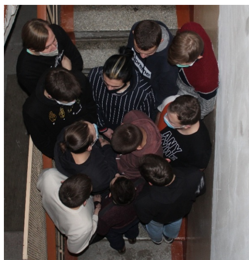
Рисунок 1.2 – Значения нагрузок на лестничной марш во взаимосвязи с интенсивностью толпы на площади 1,44 м 2 (1,2 x 1,2 м)
