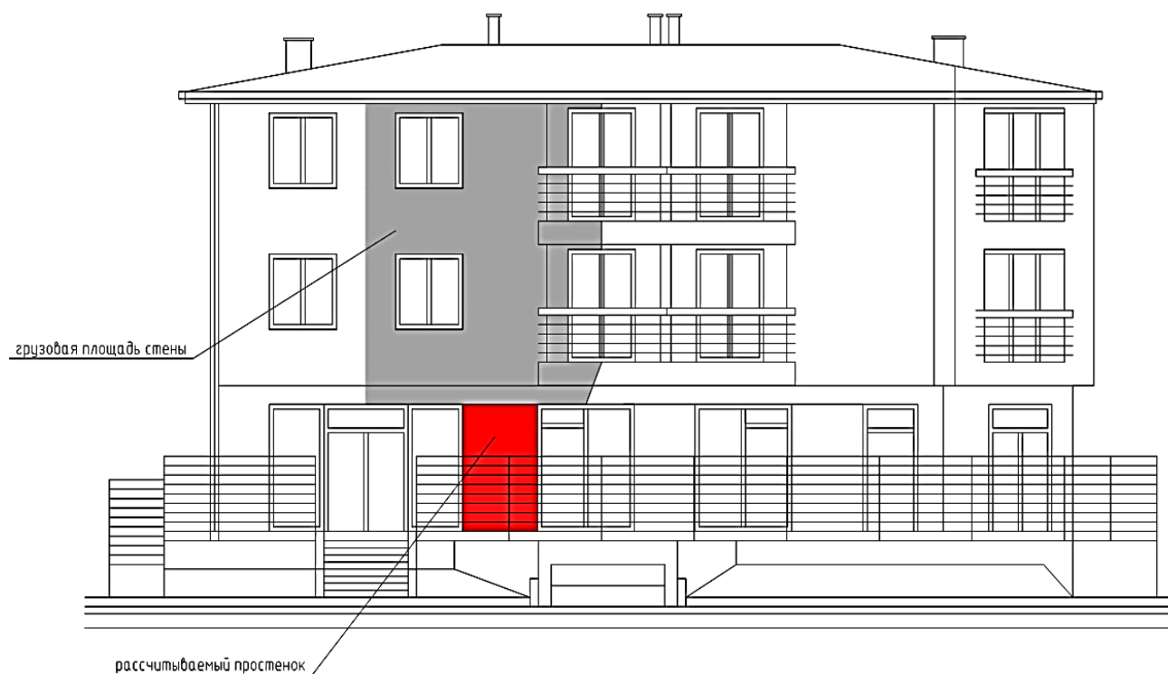
Рисунок 2.40 – Схема передачи нагрузки от вышележащих стен на рассчитываемый простенок
