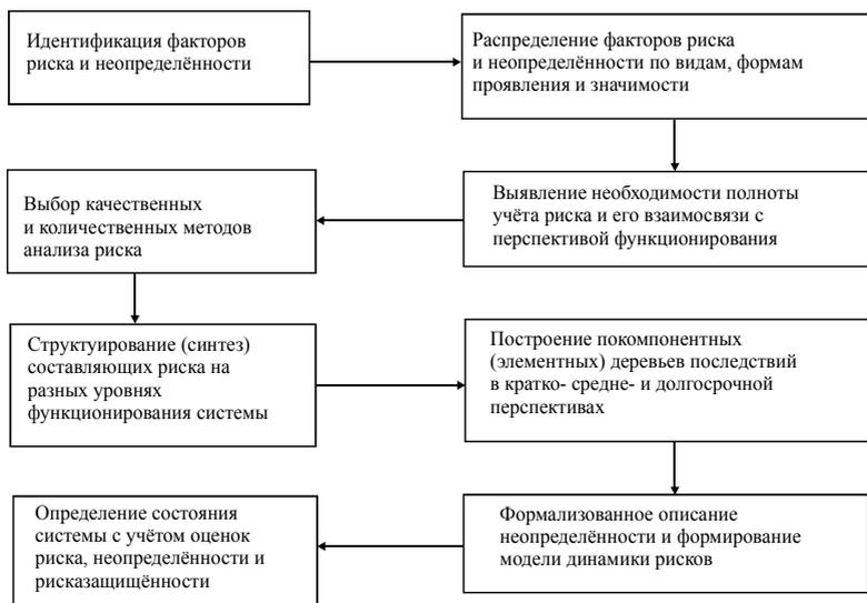
Рис. 6.6. Принципиальная схема оценки риска и неопределённости функционирования систем
