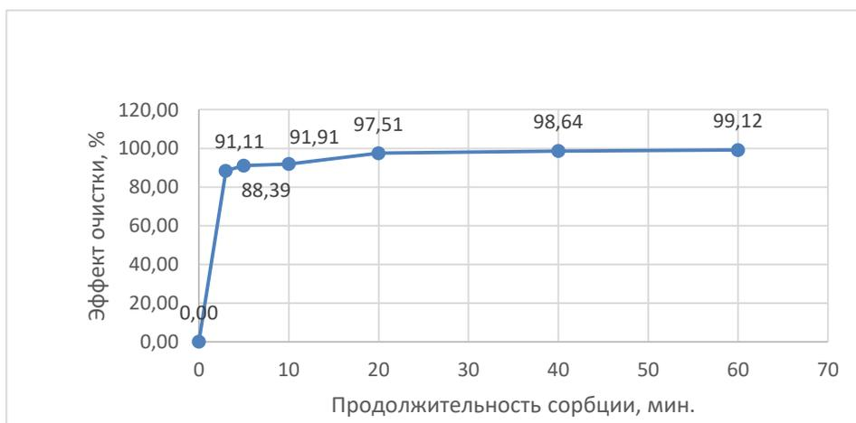
**Рисунок 6** – Зависимость эффекта сорбции ионов  $Cd^{+2}$  от продолжительности контакта, мин
