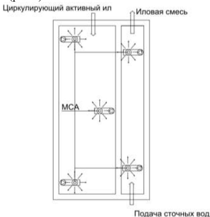
**Рисунок 1** – Технологическая схема контактно-стабилизационного аэротенка
