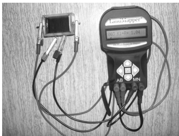
Рисунок 4.32 – Соединение прибора с кюветой для измерений электрического сопротивления в почвенных образцах
