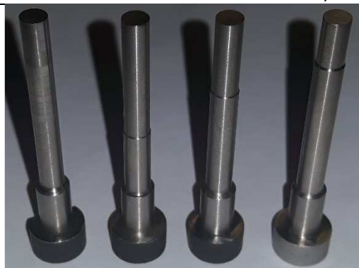
Рисунок 13 – Экспериментальная партия пробивных пуансонов ИСКГ-1550-4457.037 с изменённой длиной рабочей поверхности
