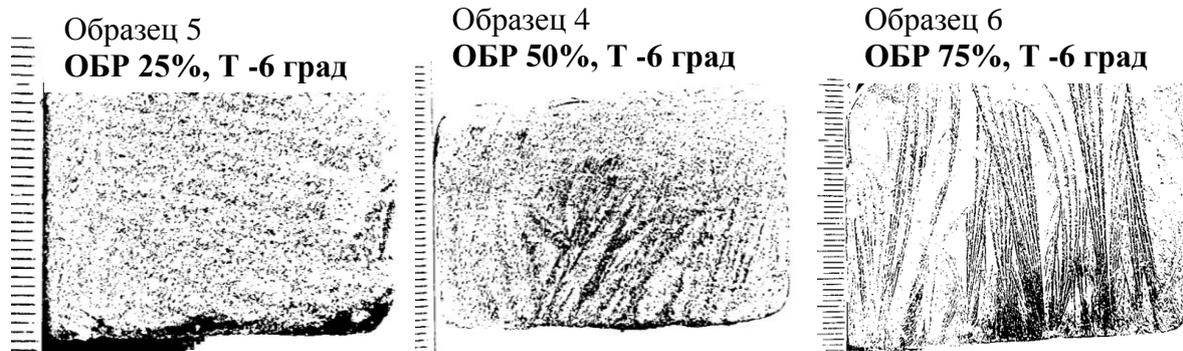
Рисунок 3 - Криогенное строение образцов № 4, № 5, № 6
