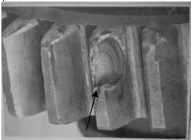
Рисунок 1 – Локальные повреждения рабочих поверхностей зубчатых колес
