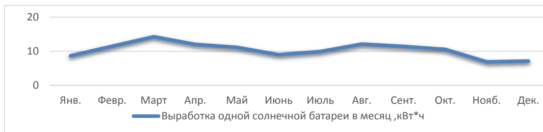
Рисунок 3 – Сезонная выработка одной монокристаллической солнечной батареи
