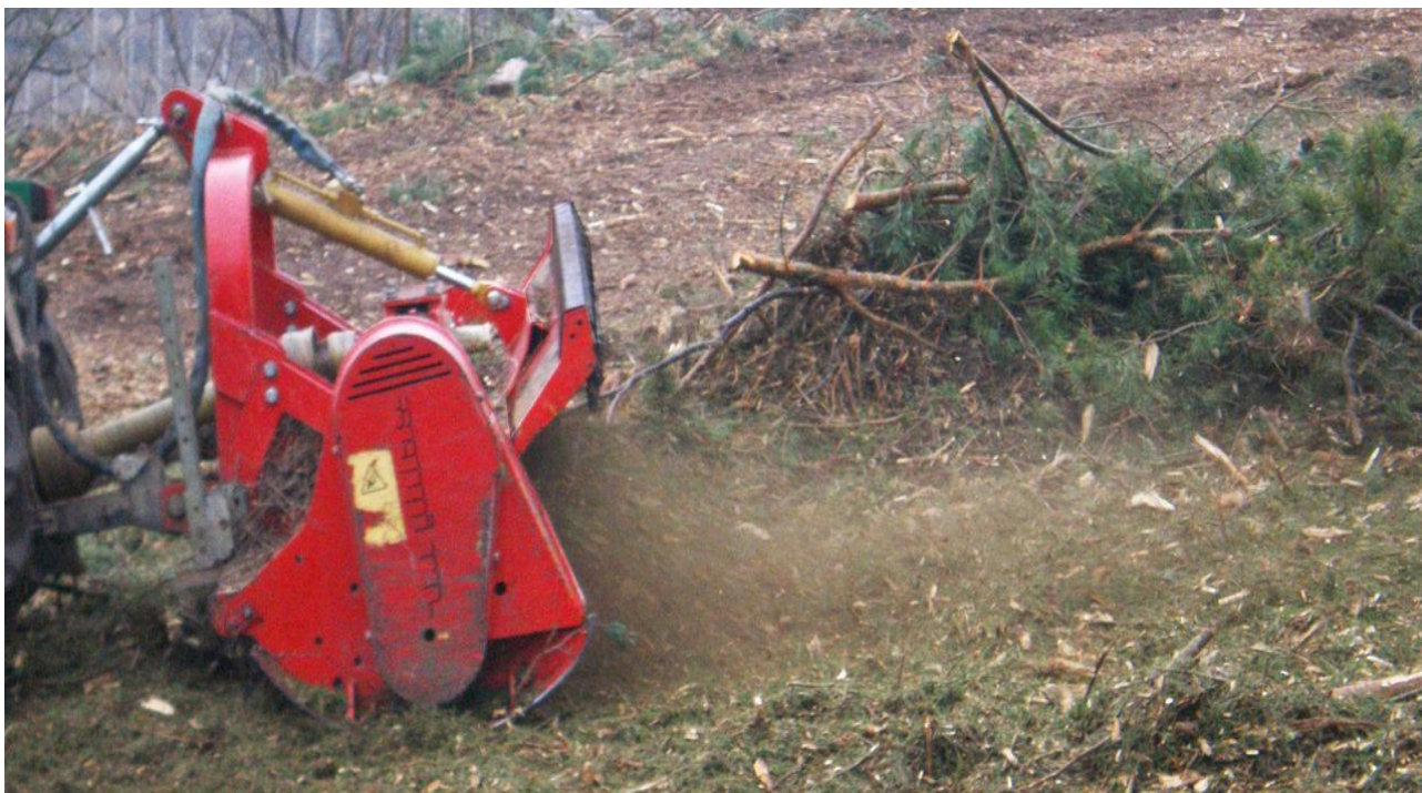
Рисунок 2 – Лесной измельчитель - мульчер Seppi M Miniforst 200
