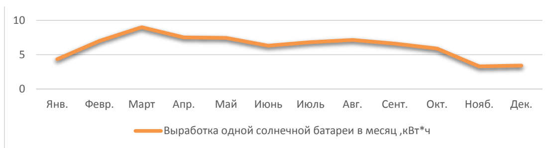
Рисунок 2 – Сезонная выработка одной пленочной солнечной батареи
