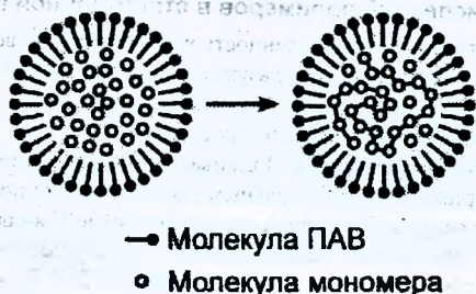
Рис. 5.2. Схематическое представление частиц в воде эмульсионной полимеризации: В мицелле с мономером после взаимодействия с инициатором образуется растущая цепь.
