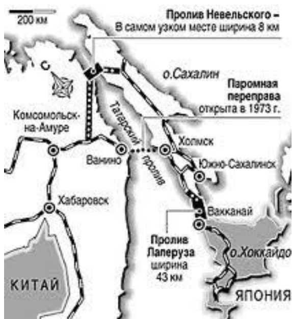
Рисунок 5 – План соединения Транссиба и железных дорог Японии (мыс Погиби – Сахалин – Хоккайдо)
