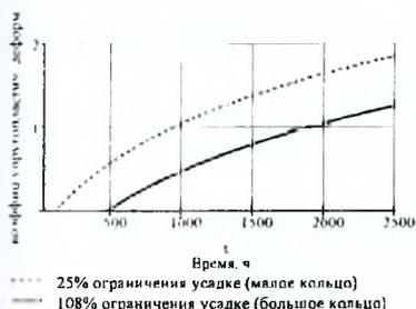
Рисунок 7 – Изменение коэффициента упругопластических деформаций при усадке
