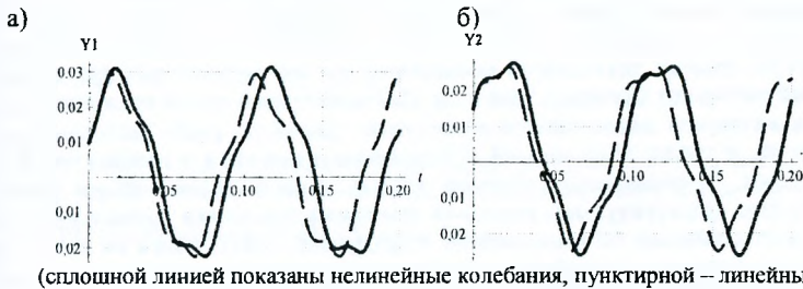
Рисунок 6 – Графики колебаний точек расположения масс на свободно опертой балке при y_1(0) = 0,01 м; y_2(0) = 0,015 м; V_1(0) = 1 м/сек; V_2(0) = 2 м/сек. а) колебания первой массы б) колебания второй массы
