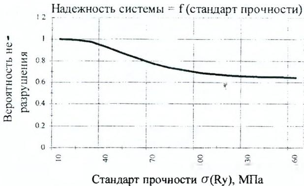
Рисунок 4 – Зависимость надежности системы от стандарта  $\sigma(R_y)$
