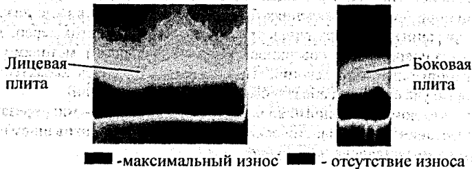
Рисунок 5 – Карта износа плит для формования кирпича 3NFD
