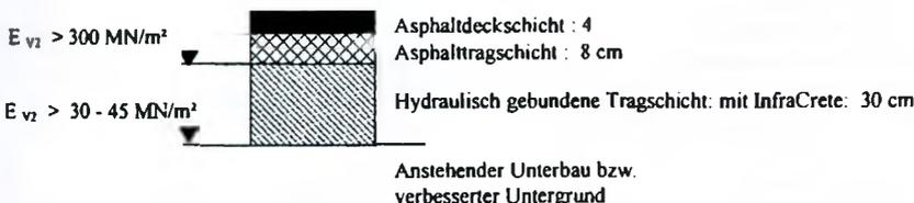
Um durch eine hydraulische Verfestigung mit dem Spezialbindemittel „InfraCrete®ST“ eine funktionsfähige Tragschicht zu erhalten, sollte bei einer Verwertung von pechhaltigen Straßenbaustoffen darauf geachtet werden, dass durch die Kornabstufung des Ausgangsgemisches die Voraussetzungen für eine tragfähige und frostsichere Tragschicht mit möglichst dichter Struktur gegeben sind.
