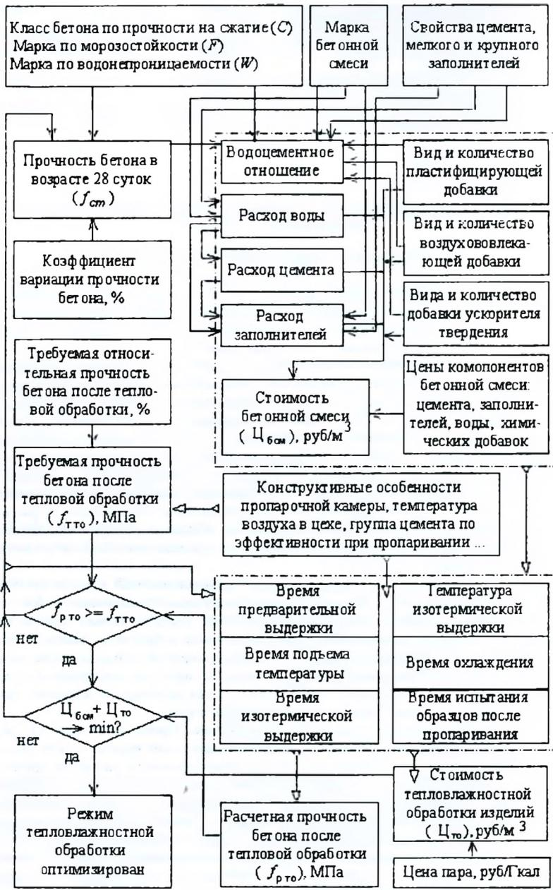
Рисунок 1 – Схема оптимизации режима тепловлажностной обработки бетона
