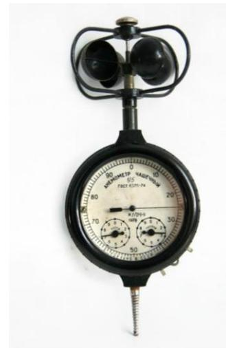
Рис. 1.9. Чашечный анемометр МС-13
