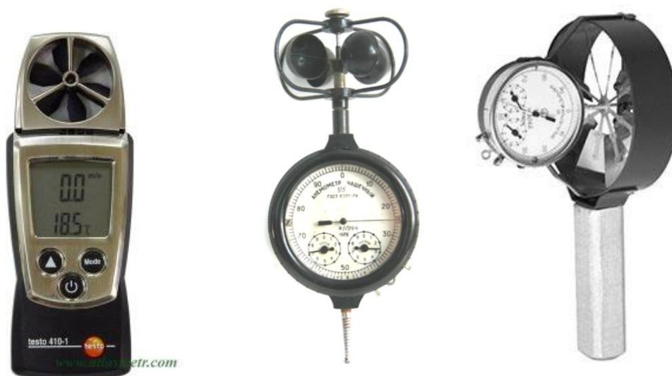
Рис. 5.2 – Термоанемометр testo 410-1. Чашечный анемометр МС-13. Крыльчатый анемометр АСО-3.
