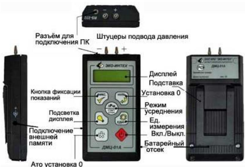
Рис. 1.5. Дифференциальный манометр ДМЦ-01М.
