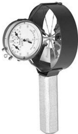
Рис. 1.8. Крыльчатый анемометр АСО-3
