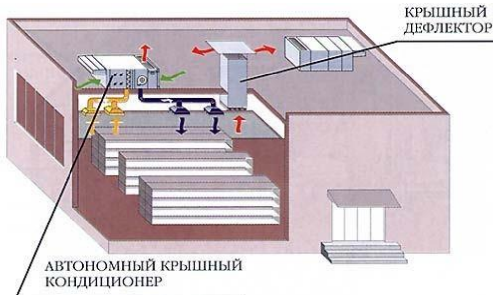
Рис.9.2 Применение крышного кондиционера
