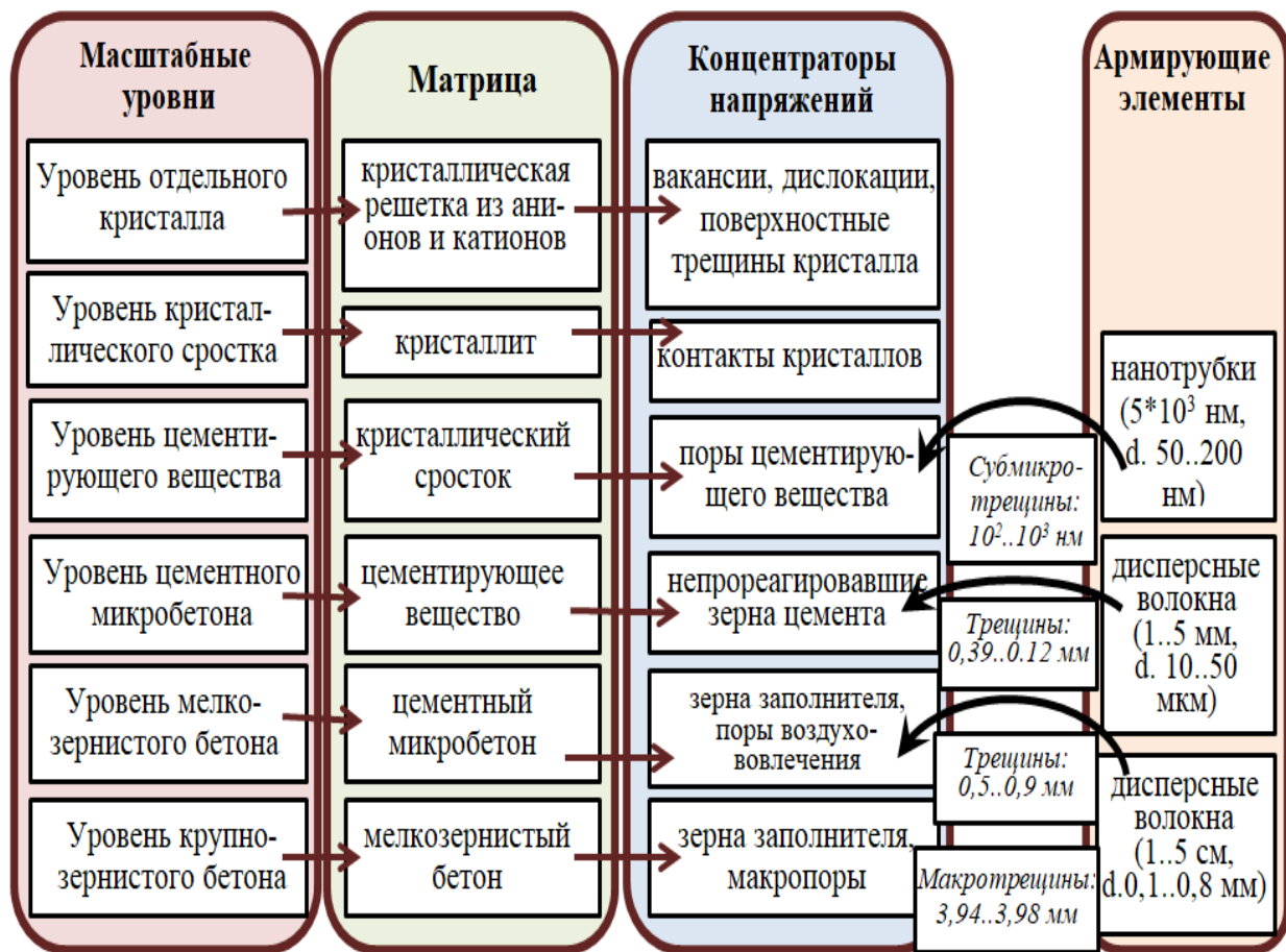
Рисунок 2 – «Масштабные уровни структуры композитов: структурные элементы (включения), как концентраторы напряжений, схема многоуровневого дисперсного армирования» [6] и армирующие элементы
