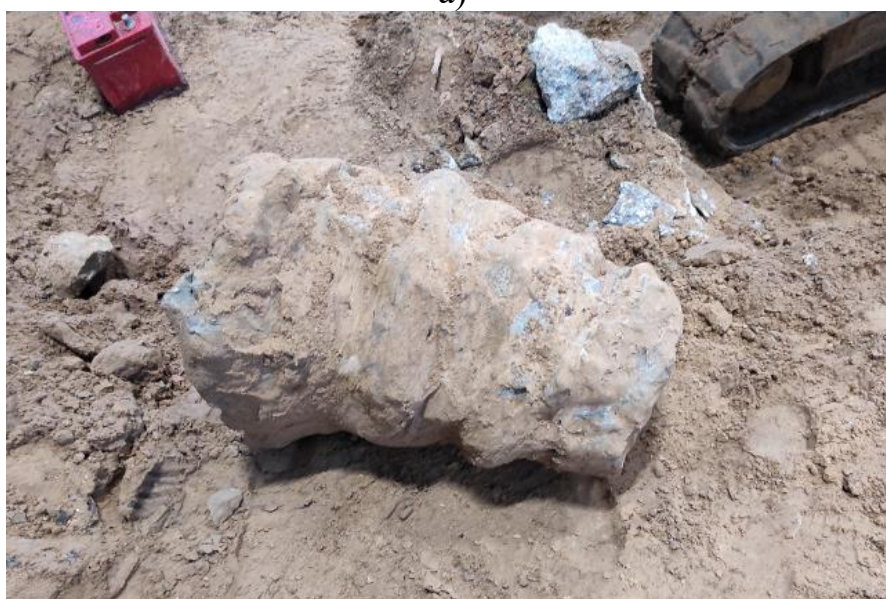
Рис.3. Устройство цемента-грунтовых свай по технологии Jet grouting: а) - общий вид установки; б) - извлеченный фрагмент цемента-грунтовой сваи
