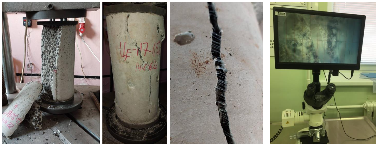
слева – неармированный керамзитобетонный цилиндр, в центре – керамзитоволокнобетонный цилиндр; справа – положение фибровых волокон в пределах раскрытия трещины Рисунок 1 – Опытные цилиндры после испытаний осевой кратковременной нагрузкой до разрушения
