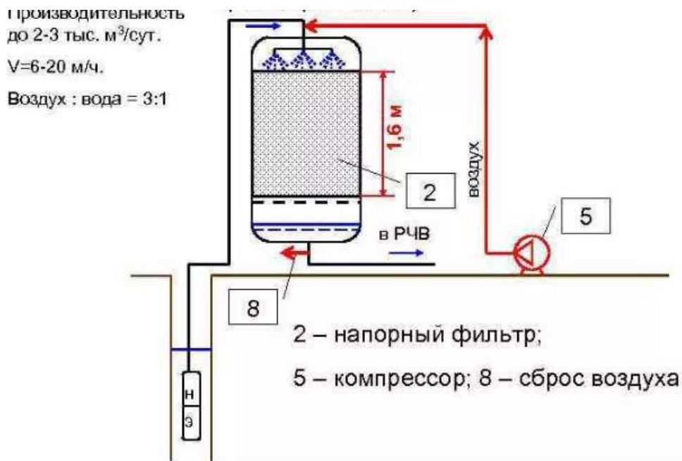
Рисунок 15.5 – Обезжелезивание методом «сухого» фильтрования
