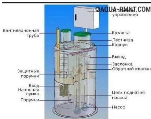
**Принцип работы канализационной станции** Независимо от типа КНС принцип работы всех систем одинаков. В приемную часть сливаются стоки, которые благодаря плотной прокладке воды не просачиваются в грунт, и под давлением принудительно прокачиваются насосами в напорный трубопровод. Далее сточные воды попадают в распределительную камеру и по трубам транспортируются
