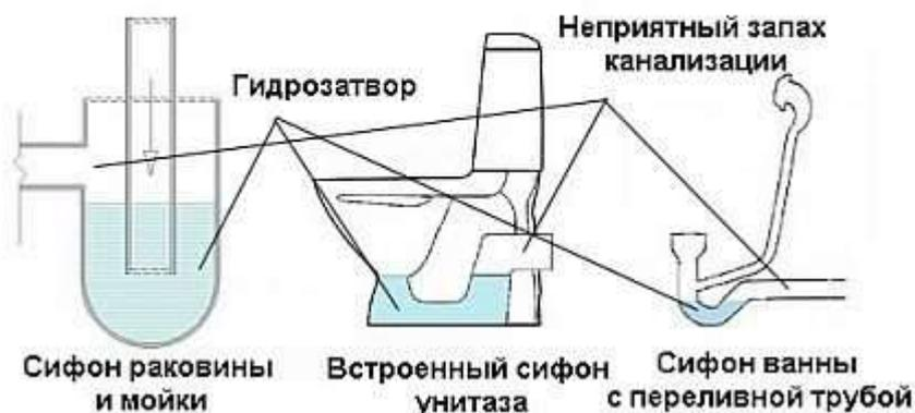
Верхняя часть стояка выводится выше кровли дома и оборудуется специальной крышкой или клапаном, которые позволяют воздуху заходить в трубу в моменты спуска воды для предотвращения сифонного эффекта и срыва
