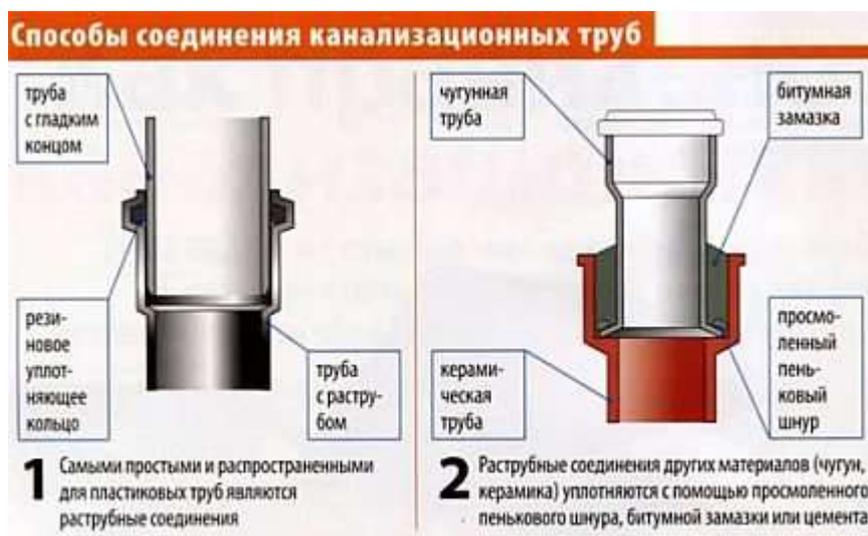
Указанные значения уклона рассчитываются на один метр трубы, поэтому если в доме от раковины идет трехметровая труба диаметром 50 мм, то разница её уровней у канализационного стояка и в месте соединения с сифоном должна составлять не менее 9 см.
