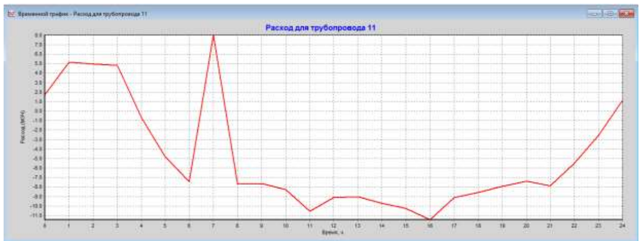
Рис. 6.13 Временной график изменения расхода воды в трубопроводе 11.
