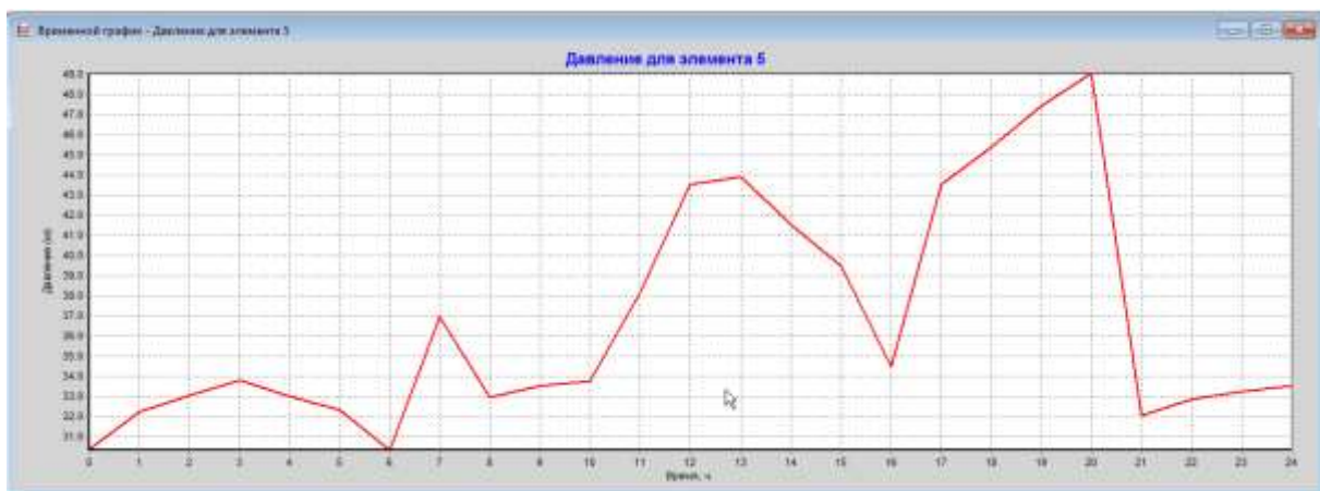
Рис. 6.15 Изменение во времени давления (свободного напора, м.) для узла №5
