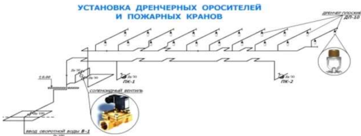
Рисунок 1 7 – Установка дренажных оросителей и пожарных кранов
