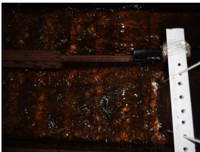
Рисунок 10 – Обтекание потока через модель с шириной сетки в 10см
