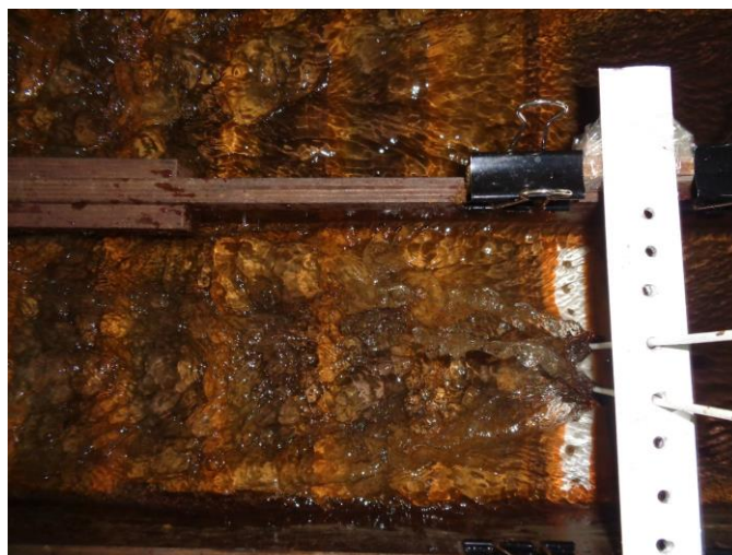
Рисунок 8 – Протекание потока через барьер пролётом 2 см
