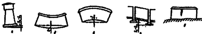
Рис. 1. Виды деформаций сооружения: а) наклон; б) прогиб; в) выгиб; г) перекося; д) трещинообразование
