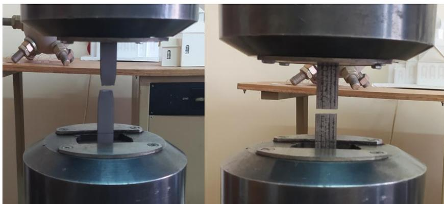
**Рисунок 2 – Испытания образцов материала на растяжение**
