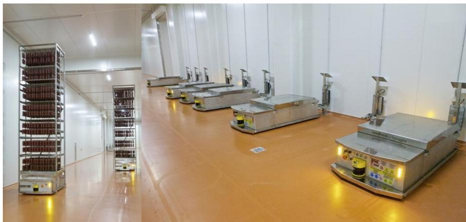
Рисунок 2 – AGV тележка фирмы TescoFerrari (Италия)
