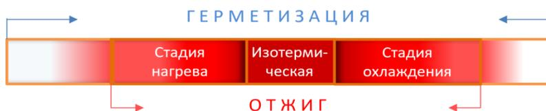
**Рисунок 2 – Схема совмещения герметизации и отжига ШД**
