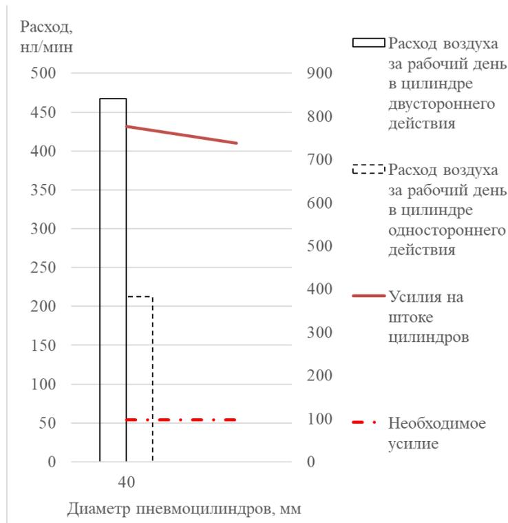
**Рисунок 3 – График потребления воздуха для цилиндров двустороннего и одностороннего действия**
