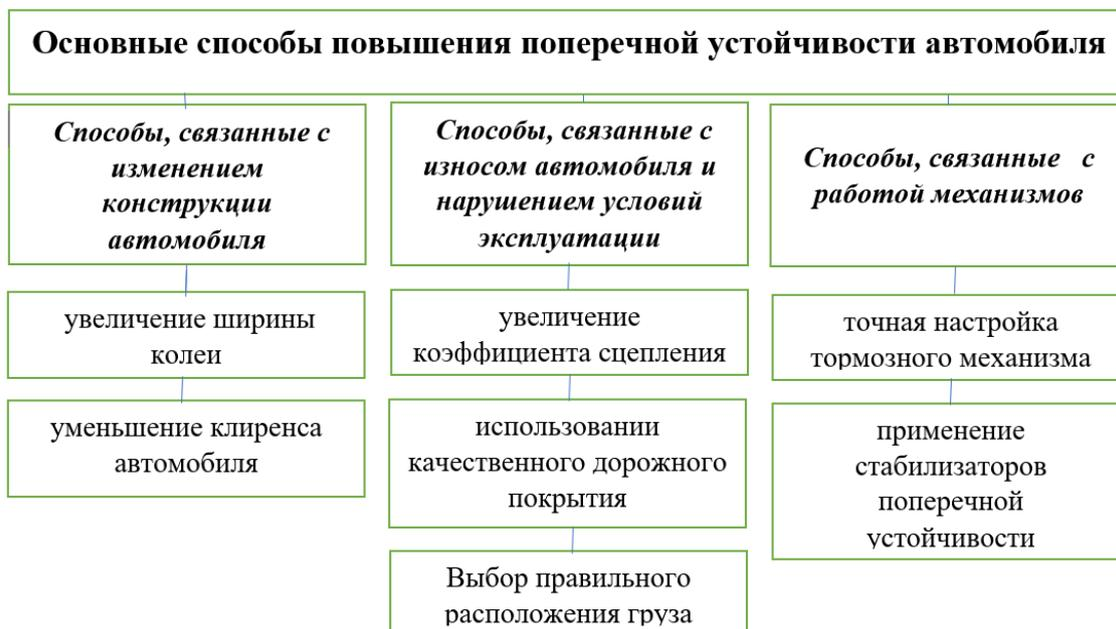
*Рисунок – 1 Типичные способы повышения устойчивости автомобиля*
