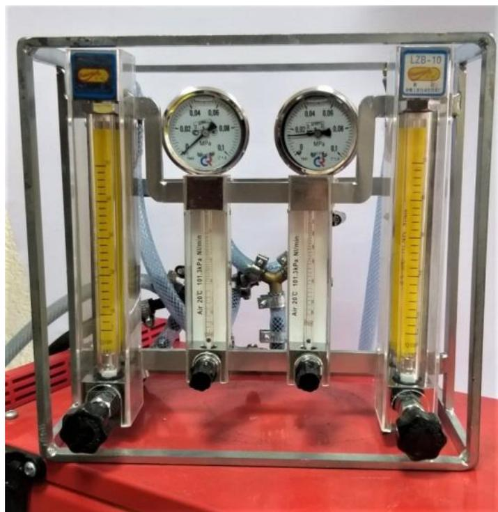
*Рисунок 1 – Установка для смешивания трехкомпонентной защитной газовой среды*
