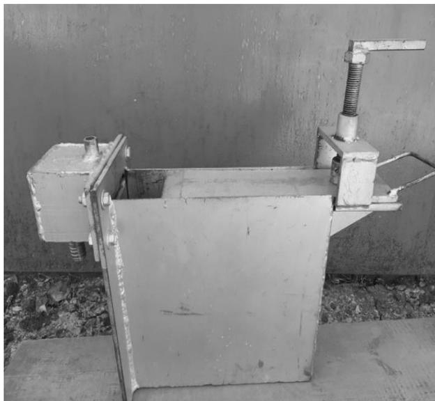
*Рисунок 2 — Установка для аэродинамического звукового воздействия*
