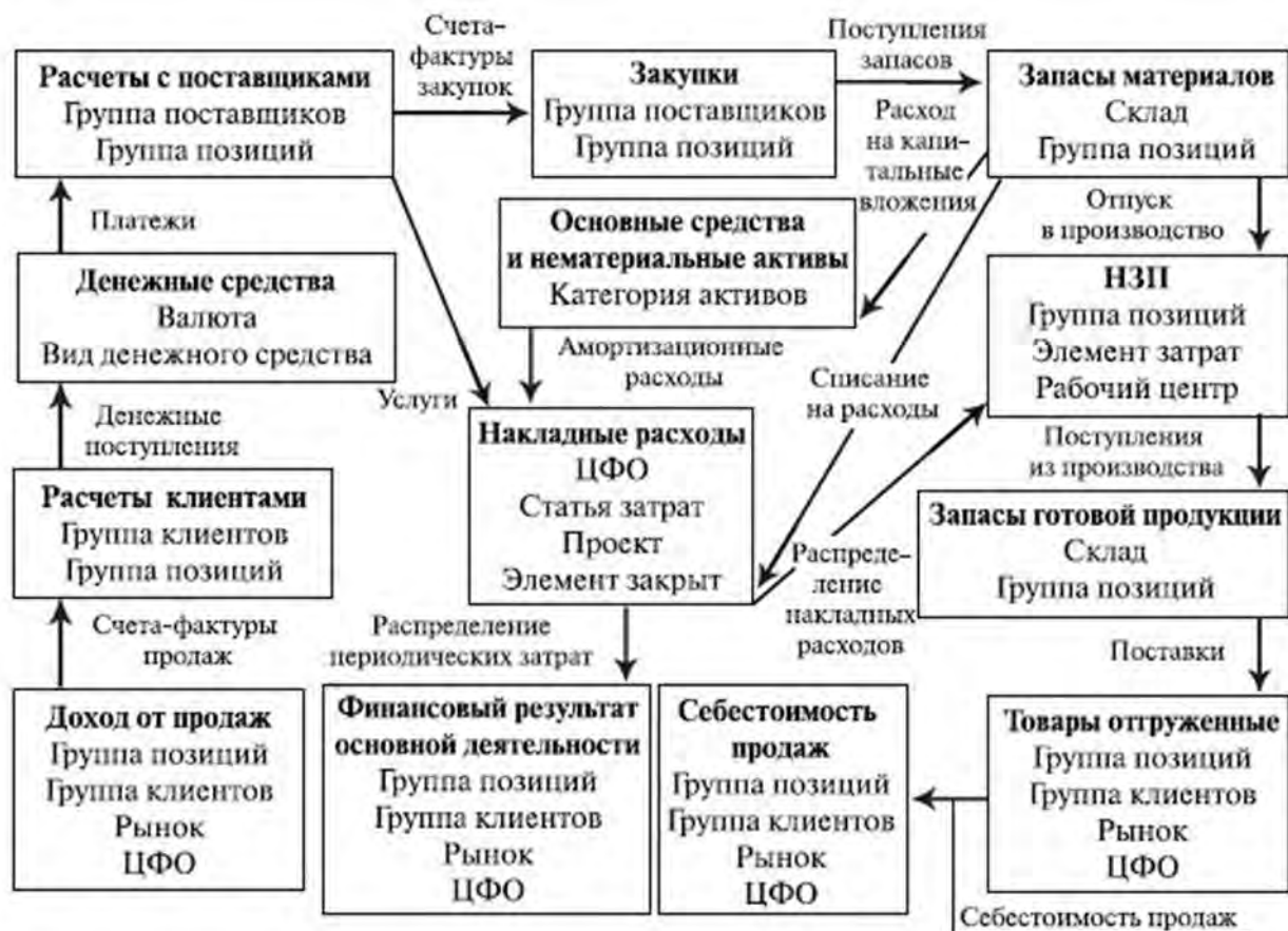
Рис. 5.19 Взаимосвязь функциональных блоков ERP системы
