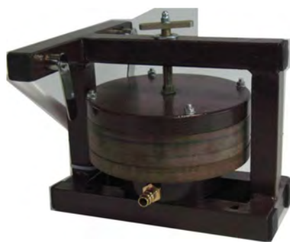
Рис. 1. – Модуль НТЦ-22.05.1/1 «Исследование теплопроводности материалов методом пластины»
