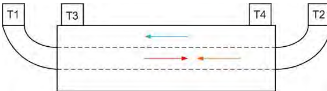
Рис. 4. Схема расположения датчиков температуры
