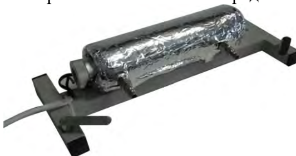
Рисунок 1. Модуль НТЦ-22.05.1/6 «Определение коэффициента излучения электропроводящих материалов калориметрическим методом»
