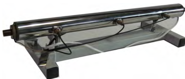
Рисунок 1. Модуль НТЦ-22.05.1/3 «Исследование теплопередачи при естественной конвекции воздуха около горизонтального цилиндра»
