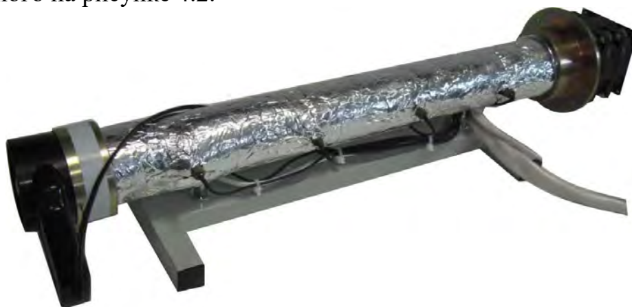
Рисунок 4.1 - Модуль НТЦ-22.05.1/1 «Исследование теплопередачи при вынужденном движении воздуха в трубе»
