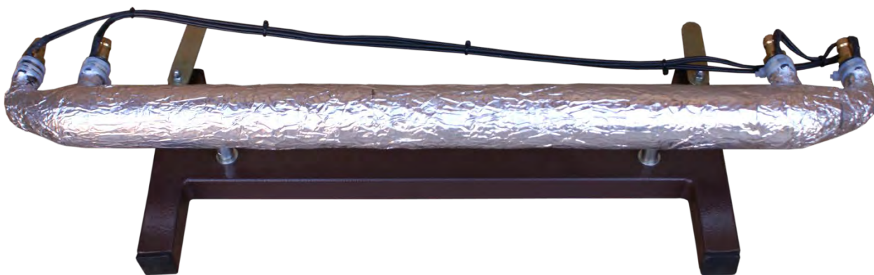
Рис. 3. - Модуль «Исследование теплового процесса в теплообменном аппарате типа «труба в трубе»»
