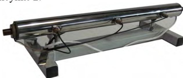
Рис. 1. — Модуль НТЦ-22.05.1/3 «Исследование теплопередачи при естественной конвекции воздуха около горизонтального цилиндра»
