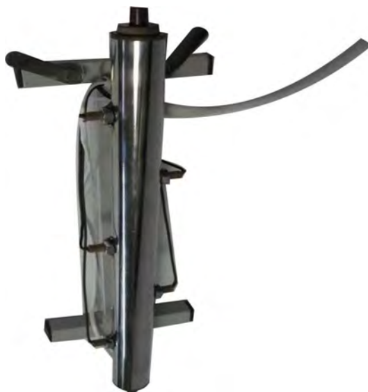
Рис. 1. Модуль НТЦ-22.05.1/3 «Исследование теплопередачи при естественной конвекции воздуха около горизонтального и вертикального цилиндра»
