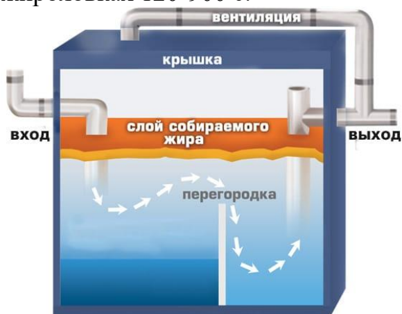
Схема очистки сточных вод после автомойки
