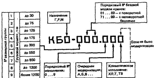
Рис.7.4. Схема индексации башенных кранов.
