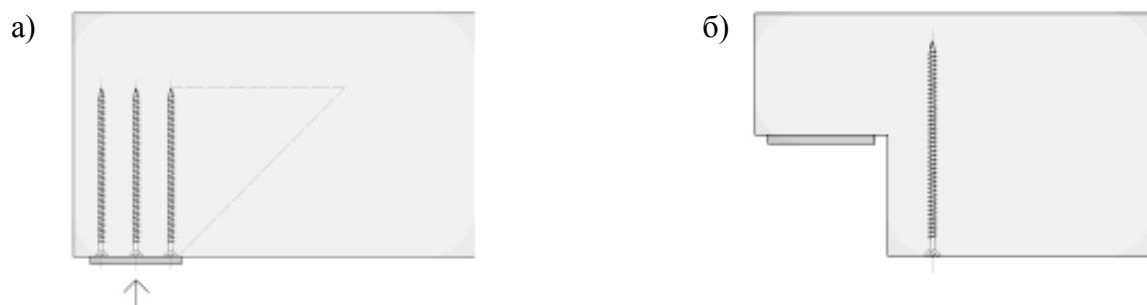
Рисунок 2 – Применение использования винтов при усилении элементов деревянных конструкций
