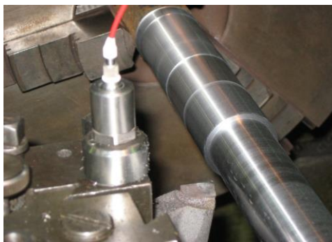
Рисунок 1 – Схема установки акселерометра при проведении эксперимента
