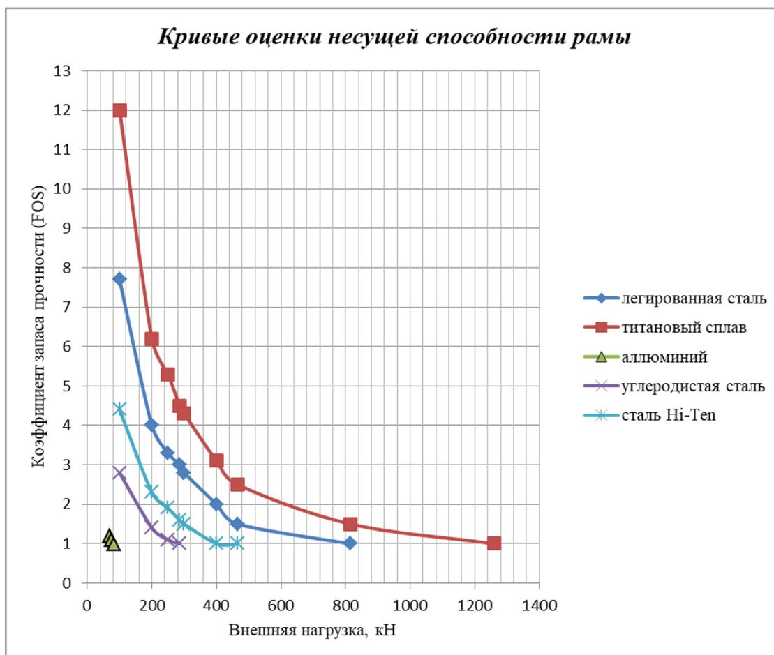
**Рисунок 6 – Несущая способность рамы из разных материалов**
