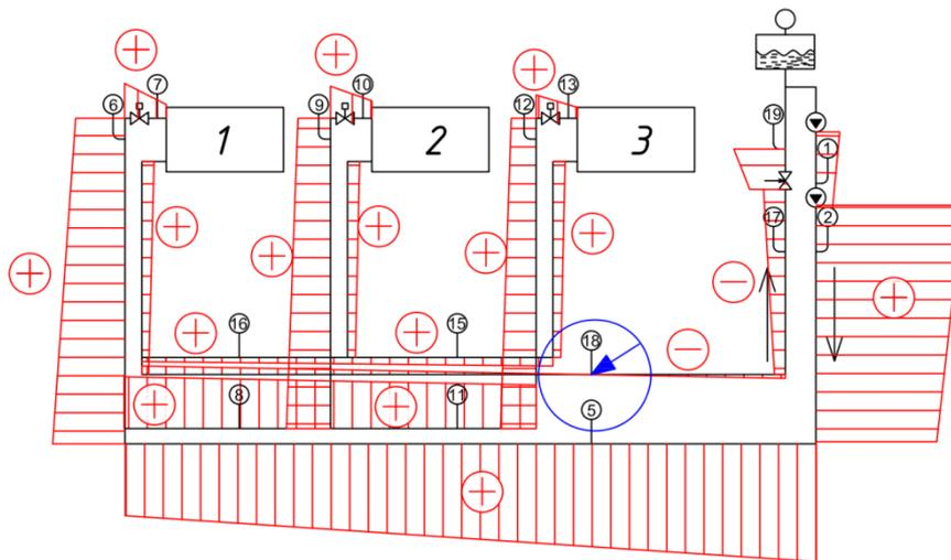
**Рисунок 6 – Схема системы отопления с двумя насосами и тремя радиаторами**
