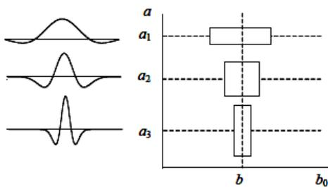
Рисунок 1 – Принцип определения вейвлетных коэффициентов  $C_{a,b}$
