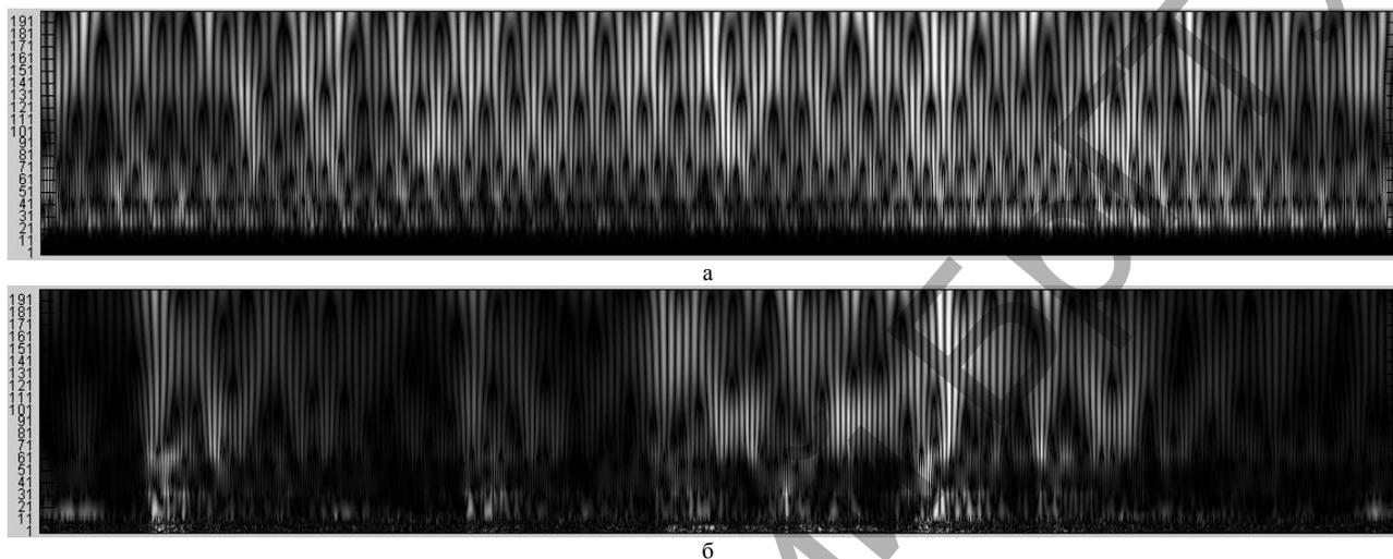
Рисунок 3 – Вейвлет-спектрограмма виброакустического сигнала работы коробки скоростей: а – при исправном колесе; б – при частичном сколе одного зуба
