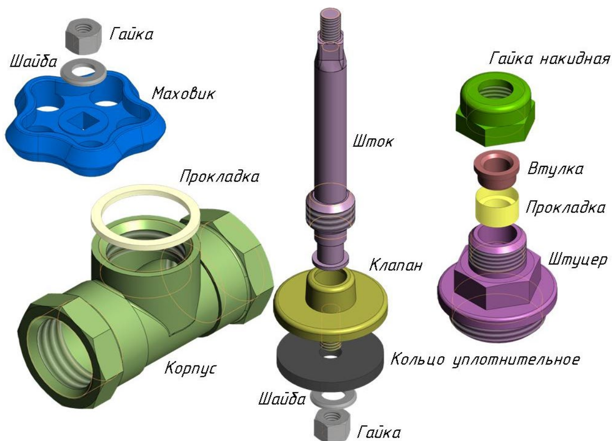
Рисунок 2 – Детали, входящие в сборочную единицу «Вентиль»
