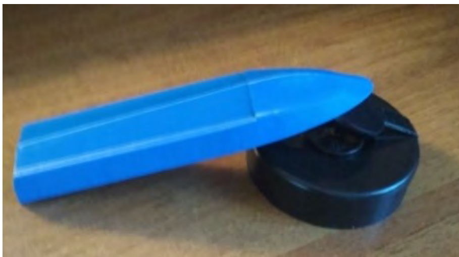
Рисунок 6 – Твёрдотельная модель (оболочка) корпуса катера
