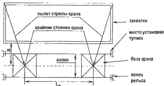
Рисунок 8.2 – Обозначение и привязка к зданию подкрановых путей
