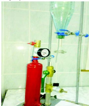
Рисунок 4. Лабораторная установка по очистке цветных маломутных вод Республики Беларусь методом напорной реагентной флотации для предприятий энергетики.
