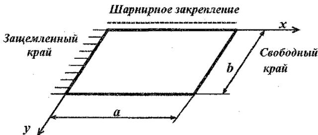
Рисунок 14 - Варианты закрепления граней пластинки
