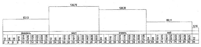
Рис. 2. Графики работы строительных машин и освоения объемов СМР (по месяцам).
