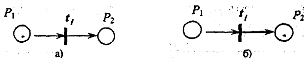
Рисунок 1.2.5 – Смена разметки сети Петри: а) до срабатывания перехода t_i ; б) после срабатывания перехода t_i .
