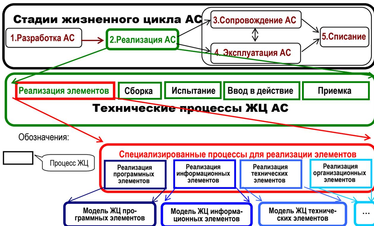
Рисунок 6.1 – Общая модель ЖЦ АС и ее элементов
